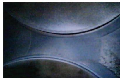
*Links: Bildausschnitt eines BHKW Kolbens. Der helle Punkt in der rechten Ecke resultiert aus der Anwendung von Blue Ignition™, die Technologie brennt Kolben und Wände von Ablagerungen frei. Der Effekt ist hier noch nicht ganz zu den Wänden fortgeschritten. Kleine ungereinigte Stellen können verbleiben.*
